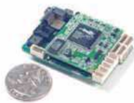
Fig. 3. Procerus Kestrel Autopilot (Beard et al., 2005).
