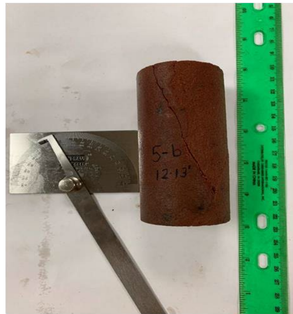
(d) Tensile failure across discontinuities
