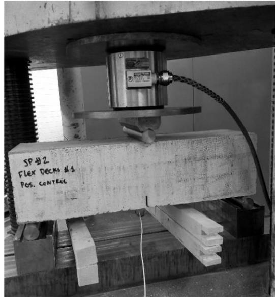
**Figure 3.2.5** FRC mini beam test setup
