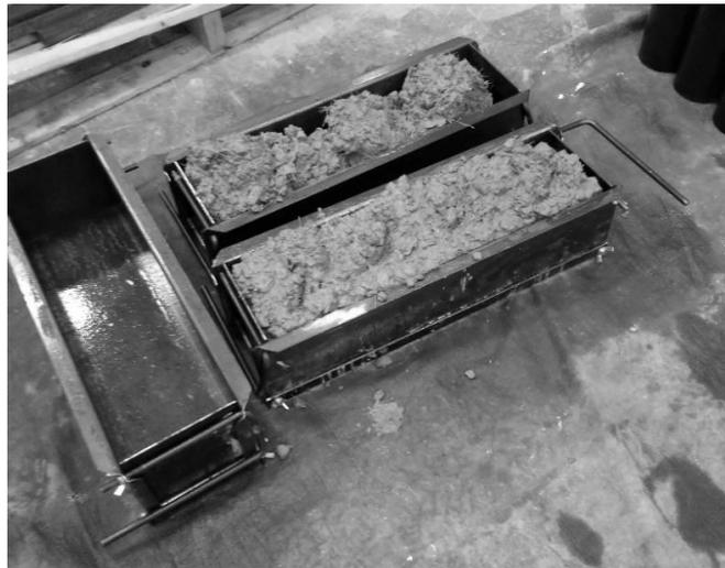
**Figure 3.2.3** Filling up the mini beam molds
