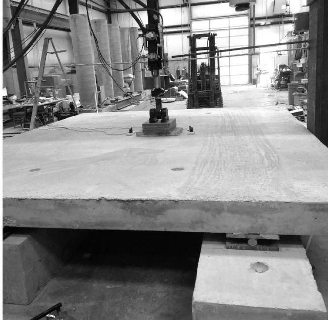
**Figure 4.3.16** Fatigue test setup 2
