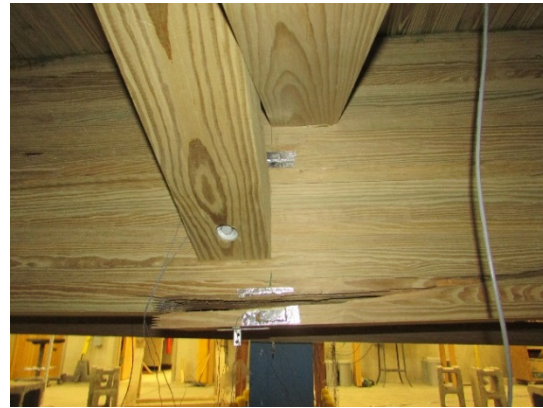
(d) Failure of Interior Girder
