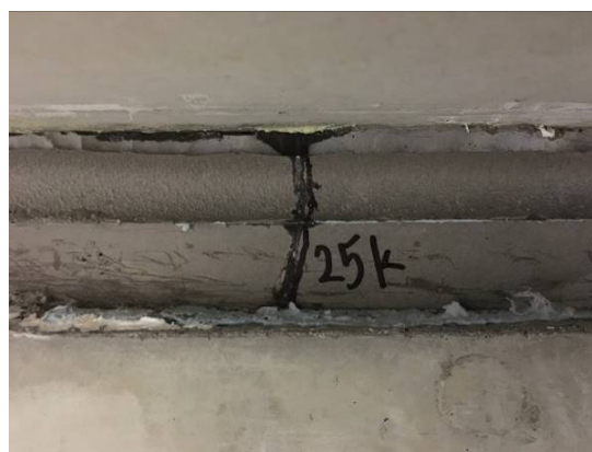
(d) Crack Condition after 650,000 Load Cycle
